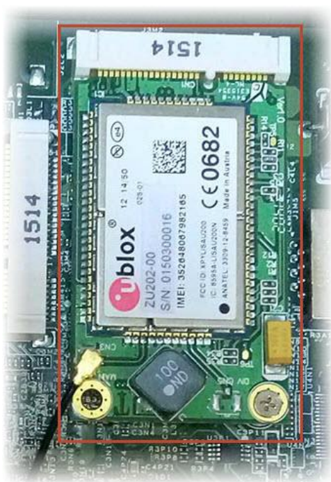
Рисунок 32. Плата mini-PCIe на HW50 N3 и HW100 N3
