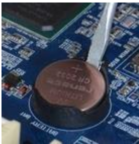
Рисунок 49. Извлечение элемента питания CMOS BIOS из гнезда на материнской плате
