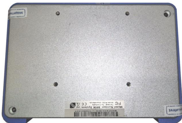
Рисунок 50. Нанесение пломбы на корпус HW100
